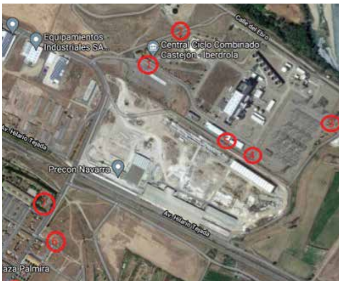
Figura 7: Puntos de control de ruido C.C. Castejón.
